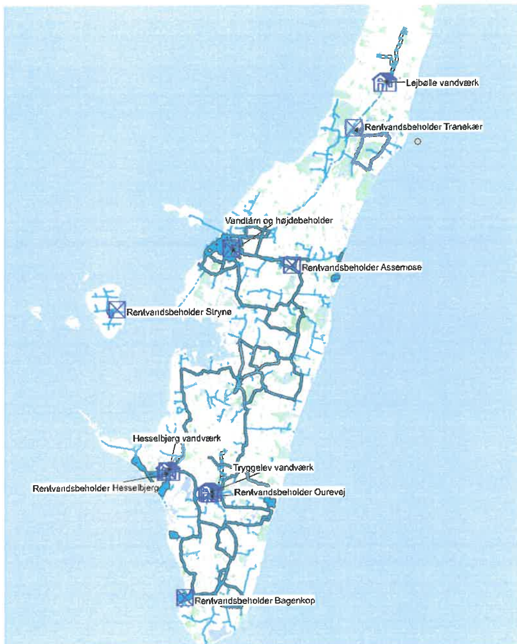
Figur 2- eksisterende anlæg Langeland Vand: vandværker, rentvandsbeholdere, vandtårn og højdebeholder.
